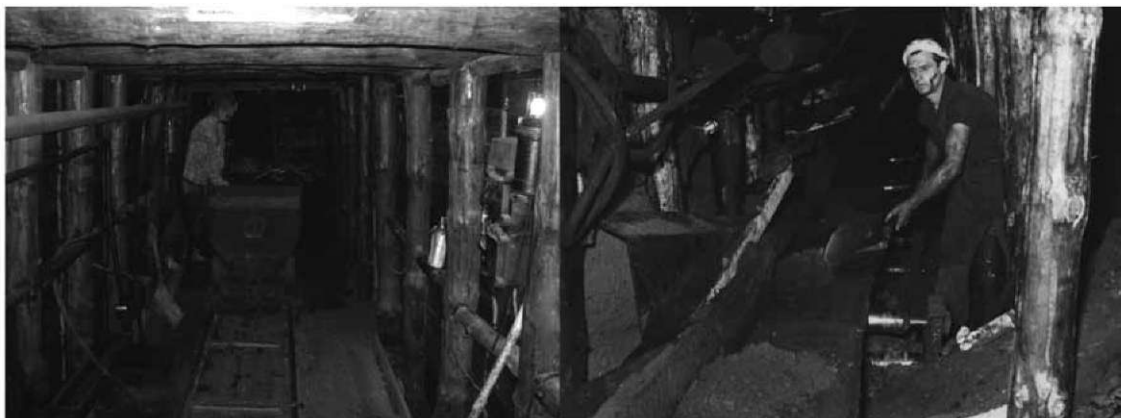
Rys. 6. Obudowa drewniana wyrobisk, fragment ekspozycji muzealnej, po lewej (foto K Probierz ). Po prawej załadunek urobku - piasków roponośnych na przodku ścianowym [6]
