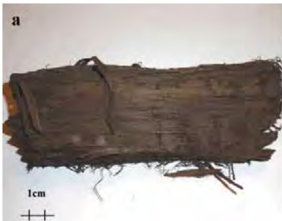
Rys. 4. Węgiel brunatny z odkrywki Welzow-Süd; a – węgiel ksylitowy rozszczepialny, b – węgiel bitumiczny Fig. 4. Lignite from Welzow-Süd strip mine; a – fissile xyloid coal b – soft coal
