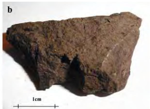
Rys. 4. Węgiel brunatny z odkrywki Welzow-Süd; a – węgiel ksylitowy rozszczepialny, b – węgiel bitumiczny Fig. 4. Lignite from Welzow-Süd strip mine; a – fissile xyloid coal b – soft coal
